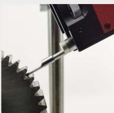
Mesure avec un support de mesure et un palpeur ZH avec patin adapté aux flancs des dents.
